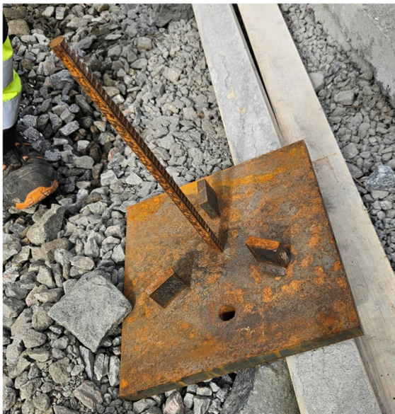
Figur 8.5 Alternativt utförande av topplatta.
