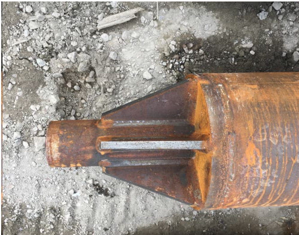
Figur 8.20 Exempel på bergsko för grov stålrörspåle.
