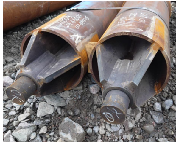
Figur 8.21 Bergsko med dubb av konstruktionsstål och pålagd svets och en öppen bergskos k "Hullspiss" försedd med härdad dubb, båda monterade på grov stålörspåle.
