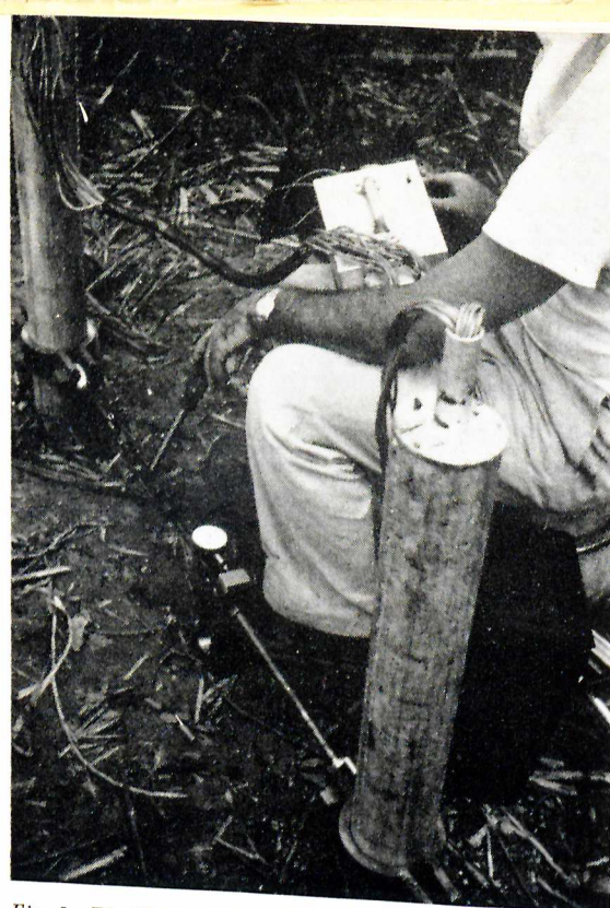
Fig 1. Försöksanordning för undersökning av fria pälars sidomotstånd.
