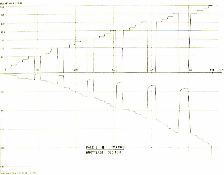
Fig 10 a. Pålskallens rörelse under provbelastningen. Pål nr 2. Över tidsaxeln redovisas belastningen och under denna rörelsen.
