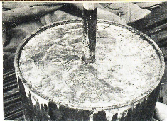
Fig 4 a (ovan). Blypackning överst på påltoppen före belastningen, och fig 4 b (nedan) efter belastningen.
