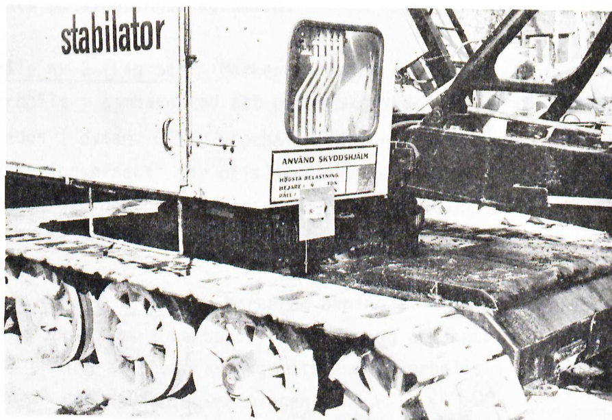
Fig 4. Pålcran med utvändigt monterat räkneverk för summering av antalet slag.
