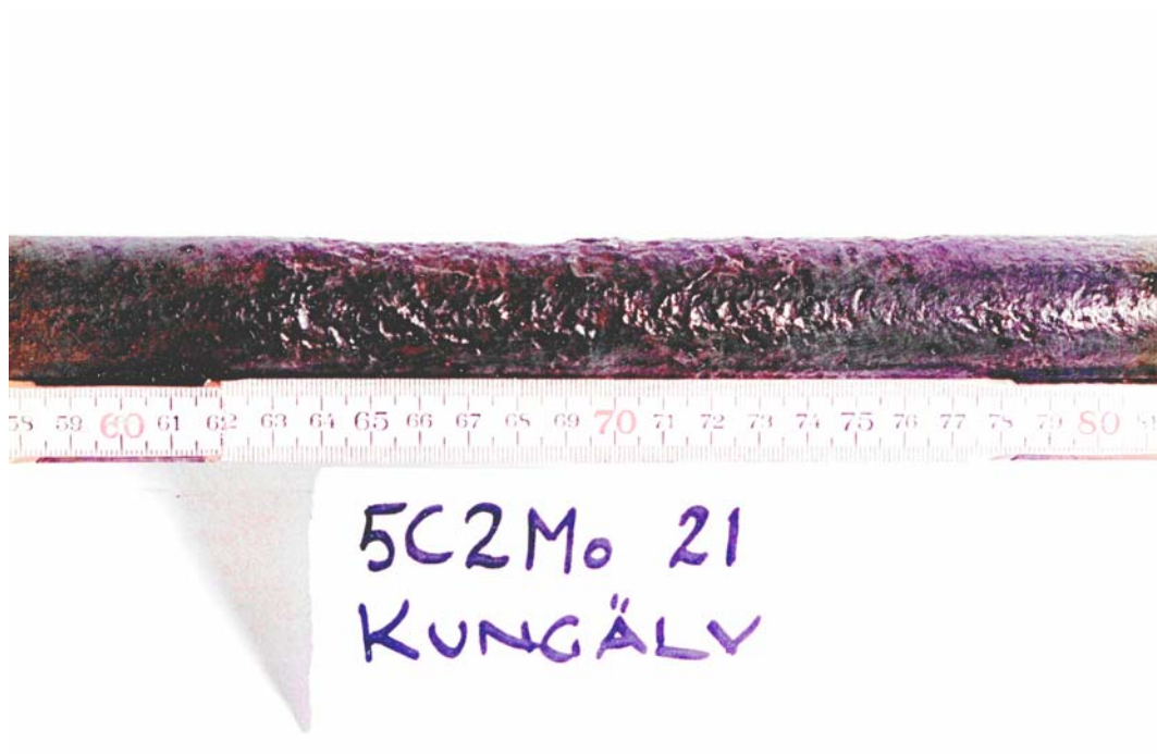
Figur 3.21. Låglegerat stål från Åkerhög vid Kungälv typ SIS 2225. Belysta detaljer.
