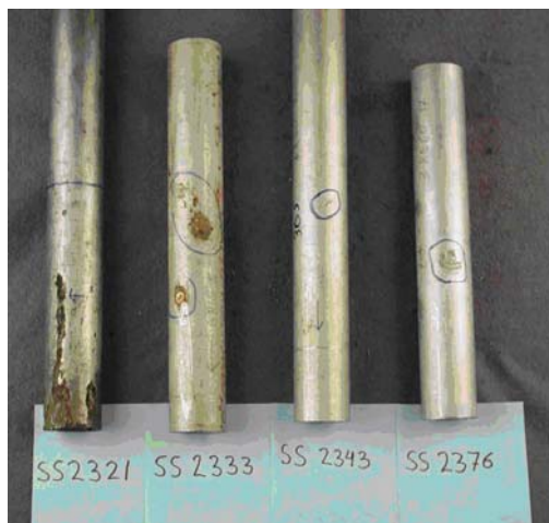
Figur 3.24. Största angripna ställe på mest angripna rör- prov från vardera av de fyra rostfria stålqualite- terna. Samtliga rör har stått på provnings- platsen med den högsta jordkorrosiviteten, Åkerhög/Kungälv, marin lera.
