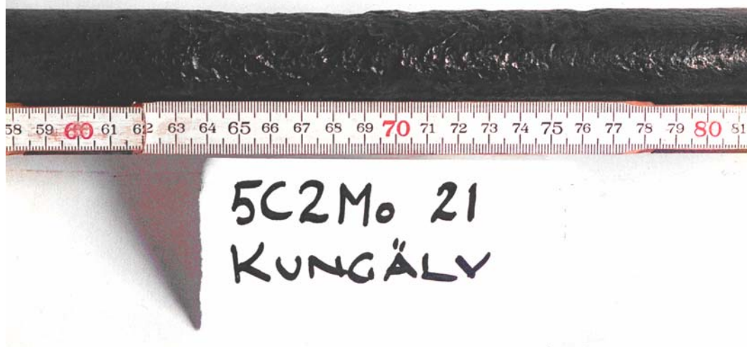
Figur 3.20. Låglegerat stål från Åkerhög vid Kungälv typ SIS 2225.
