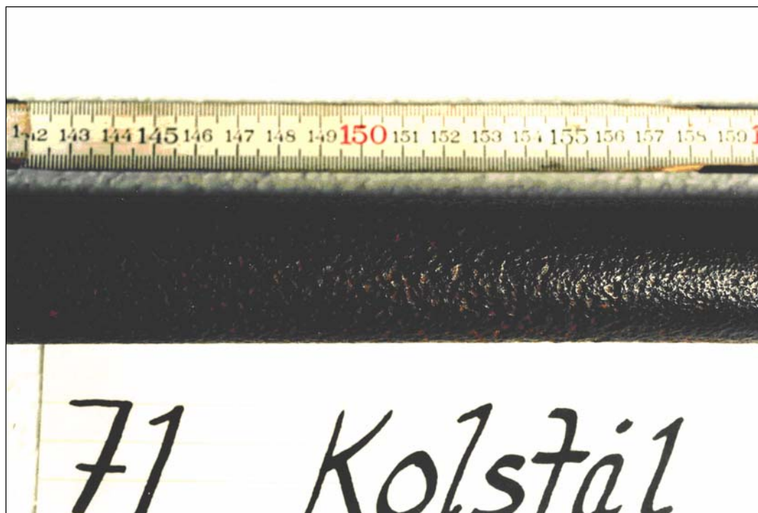
Figur 3.22. Rör av kolstål från Näre- fors vid Lidköping.
