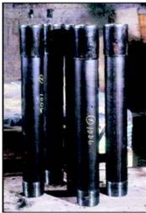
Figur 5. Skarvning av RD-påle med gängor och yttre hylsa (Ruukki).
