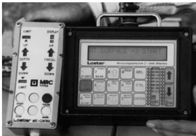
Figur 12. Elektronisk proces- styrning vid jord- packning enligt MRC-metoden.
