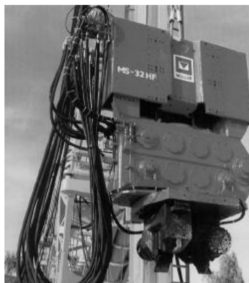
b) Nollamplitudsvibrator av typ Müller, MS-32 HF VAR – tredje generationen.
