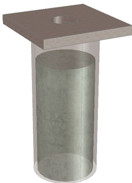
Figur 5.1. Håltagning i tryckplatta för efterinjektering av vertikala pålar. Hålets storlek anpassas så att luft kan tränga ut i samband med gjutning.
