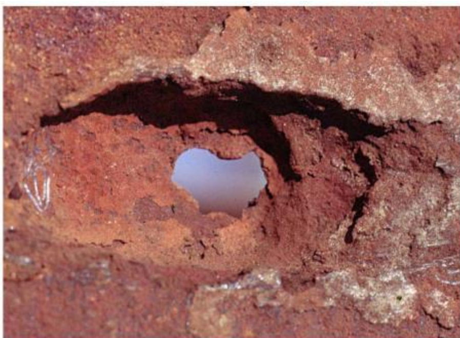
Figur 3-3. Frätgrop i stålplåt (Mattsson 2009).
