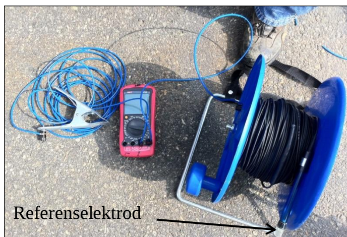
Figur 11-6. Utrustning för potentialmätning. Klämman fästs i sponten. Dykaren håller referenselektroden mot sponten och värdet läses av på voltmeteren av person på kajen.
